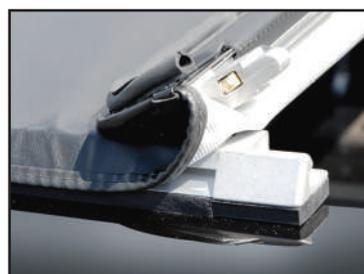
L'ouverture de la bâche se déverrouille par l'intérieur après ouverture du hayon (on ne peut donc pas les déverrouiller de l'extérieur si le hayon est fermé à clé).
