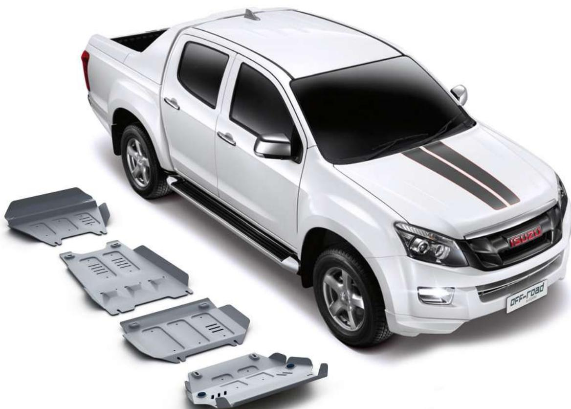
Les protections acier 2.5 mm offrent une résistance égale à l'aluminium. En cas de choc important, les plaques sont embouties, la protection se déforme afin d'absorber le choc et ainsi limiter l'incidence sur le châssis. Chaque protection Acier est pensée pour répondre à cet aspect technique.
