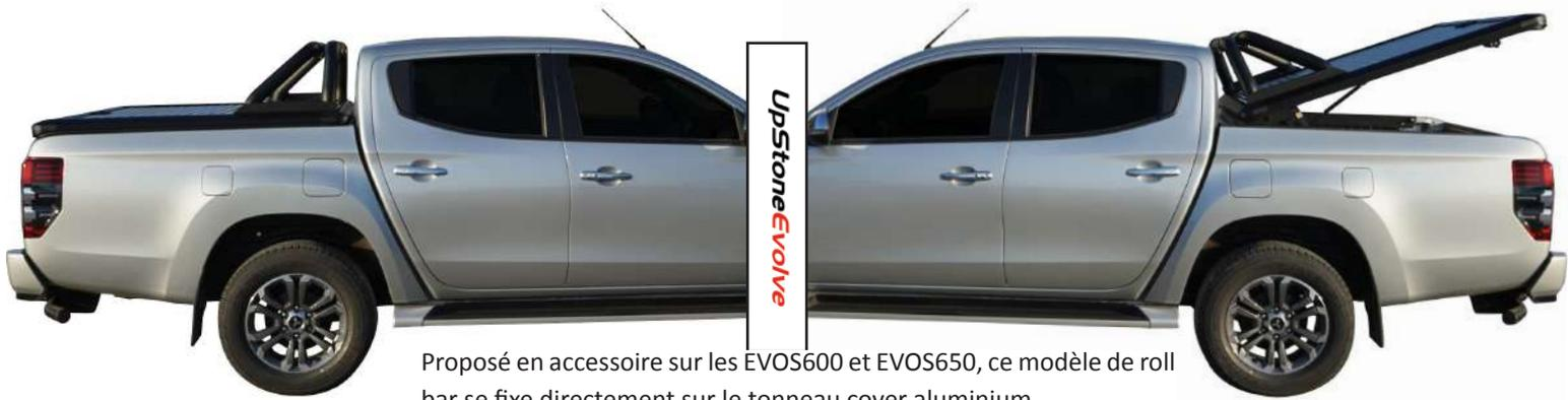
Proposé en accessoire sur les EVOS600 et EVOS650, ce modèle de roll bar se fixe directement sur le tonneau cover aluminium.
